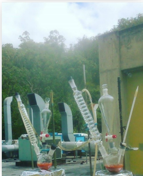
Figura 1. Montaje experimental para la fotodegradación de aguas agrias petroleras utilizando lodo rojo CVG-Bauxilum neutralizado y calcinado.
